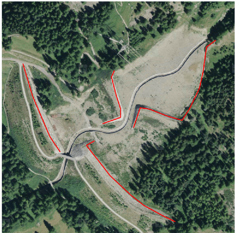
Fig. 16: Esempio di opera di contenimento (per misurare la singola opera è necessario sommare la lunghezza delle linee rosse)
